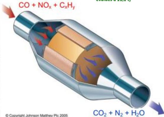
Figure 6 - Écorché et schéma d'un pot catalytique simple (© Johnson Matthey Plc).
